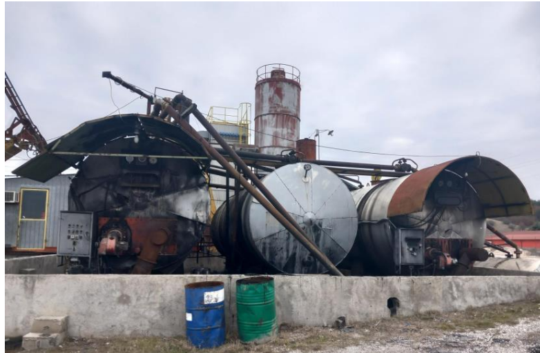
Слика бр. II.15 - Три надземни термоцистерни за складирање битумен во втечната состојба, секоја со капацитет од по 35 t. Термоцистерните се загреваат со пламеници преку греен медиум терманол
