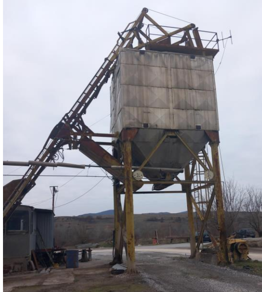
Слика бр. II.8. - Термосилос за готов асфалт со капацитет од 100 t. Термосилосот се загрева преку греен медиум терманол
