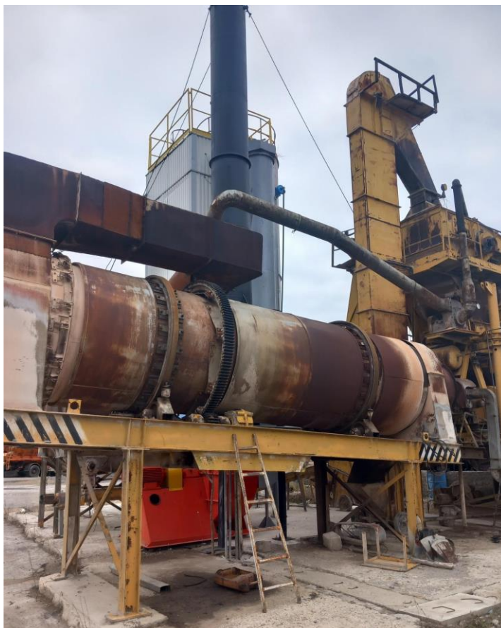
Слика II.3. Асфалтна база – Подружница Штип при ЈП за одржување и заштита на магистралните и регионалните патишта – Скопје ц.о. Проектиран капацитет: 40 t/h.
