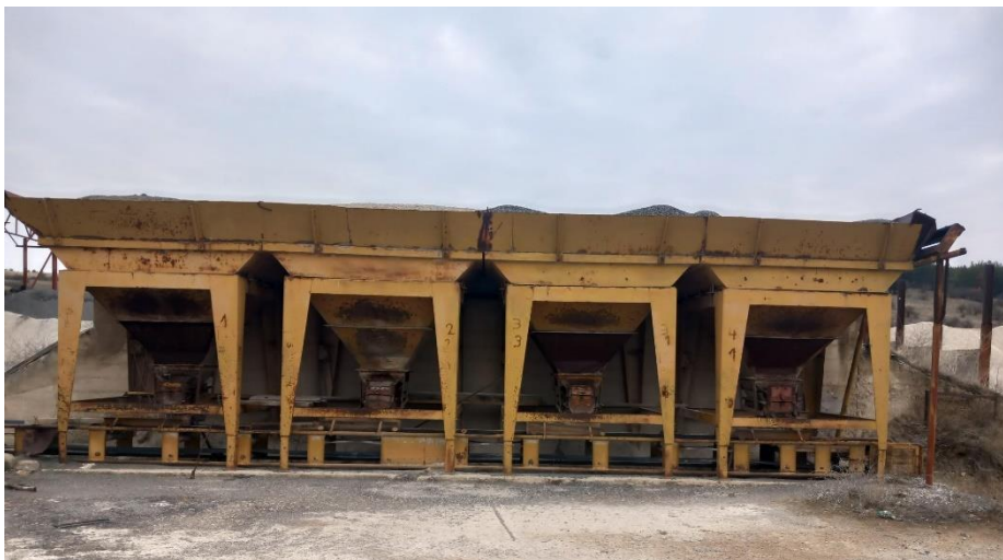
Слика бр. II.14 - Бункери за различни фракции камен материјал (ризла) со димензии од 0-4, 4-8, 8-16 и 16-22 mm. Бункерите се поврзани со транспортна лента за дозирање на ризлата во ротационата сушара
