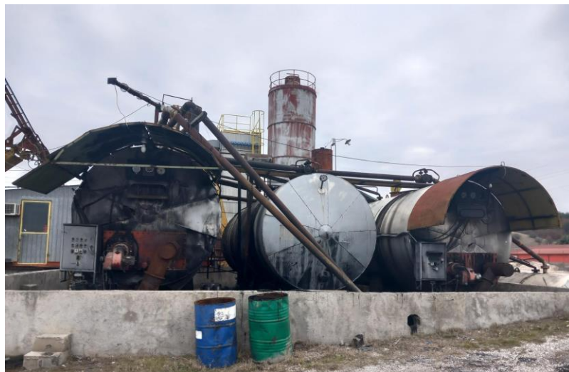
Слика бр. II.6. – Три надземни термоцистерни за складирање битумен во втечната состојба, секоја со капацитет од по 35 t. Термоцистерните се загреваат со пламеници преку зелен медиум терманол
